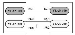
Figure 6-3 : Per-VLAN Mode STP/RSTP
