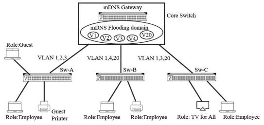
Figure 35-19 : Gateway Mode Setup
